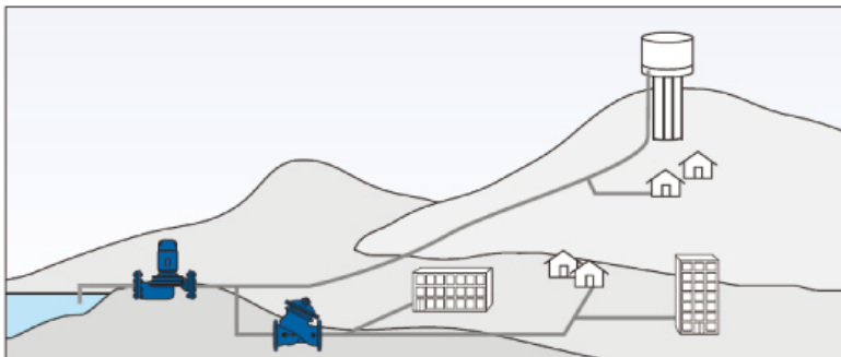
Системи за регулиране на налягането – начин на монтаж
